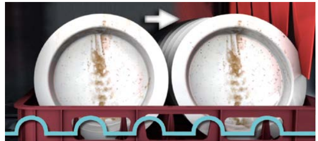
Système d'avancement standard des paniers : pas de contact homogène avec l'eau de pré-lavage
