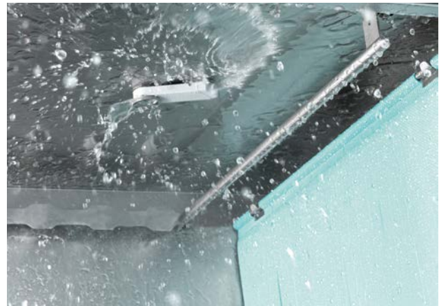
Gicleur de nettoyage de la paroi supérieure
