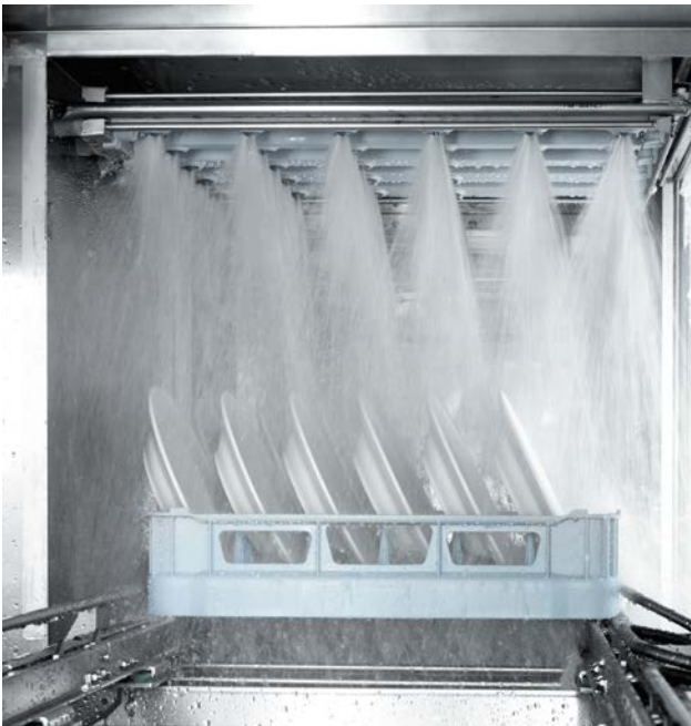
Système d'avancement standard des paniers : pas de contact homogène avec l'eau de pré-lavage
