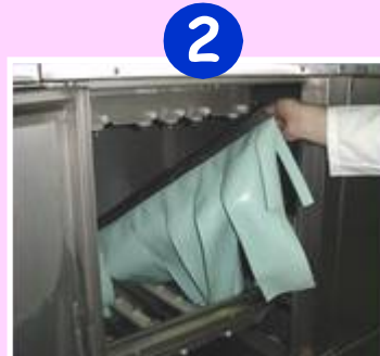
2 Démonter les parties amovibles (rideaux, rampes, tamis, filtres).
