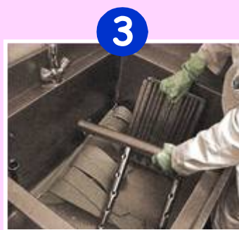
3 Tremper et brosser les parties amovibles dans la solution désinfectante. Rincer à l'eau claire.
