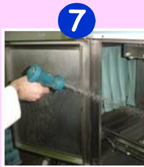
7 Rincer l'intérieur de la machine à l'eau claire.
