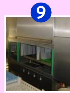
9 Laisser sécher la machine avec les portes ouvertes.
