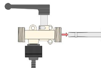
En cas de dysfonctionnement, extraire l'insert "Venturi" et le remplacer par la pièce de rechange fournie.
