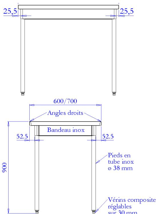
Dessus inox renforcé par un panneau collé en mélaminé hydrofuge de 19 mm. Coins pliés, bords droits tombés de 40 mm
