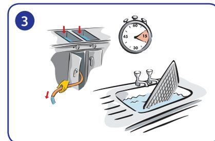
Allumer la friteuse et laisser tremper la solution nettoyante pendant 10 à 30 minutes à 90°C. Ensuite laisser refroidir la solution et vidanger la friteuse.
