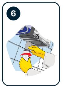
Pousser et tourner le connecteur dans le sens des aiguilles d'une montre.
