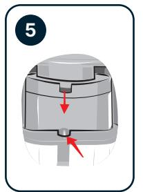
Aligner les ergots du SafePack avec ceux du connecteur de la ligne d'aspiration.
