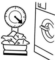
Adapter le poids du linge à laver en fonction de la capacité de la machine et de la nature du textile.
