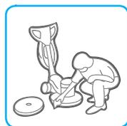
6. Nettoyer la machine à l'aide d'une chiffonnette humide sans oublier le câble. Enrouler le câble sans le tendre.
