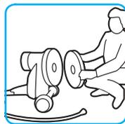
4. Tourner ou changer le disque lorsqu'il est saturé.
