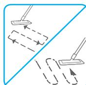
5. Appliquer la seconde couche et les suivantes si nécessaire. (il est généralement conseillé d'appliquer trois couches).
