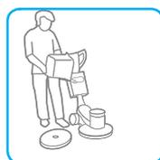
1. Sur la surface préalablement dégagée, passer l'aspiro-brosseur. Traiter localement les taches à l'aide des détachants de la gamme TASKI Tapi. Préparer une solution de TASKI Tapi Shampoo à 10%. Verser cette solution dans le réservoir à eau de la monobrosse basse vitesse équipée d'une brosse à shampoing humide.
