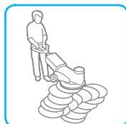
3. Brosser la moquette à l'aide de la monobrosse. Travailler en reculant et en effectuant des mouvements circulaires.
