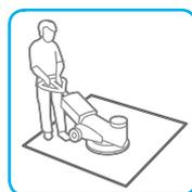
2. Vérifier la nature du support sur lequel la moquette est posée. Tester, sur une zone peu visible, la tenue de la couleur de la moquette et la compatibilité des matériaux. Commencer par le fond de la pièce. Brosser sur un endroit de moquette jusqu'à ce que le shampoing mousse.
