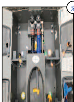
Retirer les poches et lignes d'aspirations
