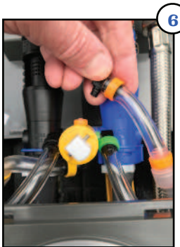
Declipser la ligne d'aspiration à dépanner
