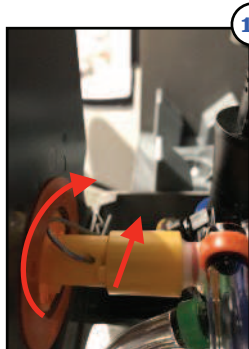
1 Verrouiller avec la goupille 2 Attention rotation bouton libre de tout mouvement
