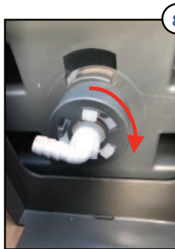
Tourner d'un quart le spigot du support
