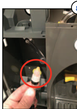
Insérer la buse calibrée en fonction du produit voir tableau
