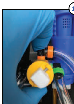
Remettre la ligne d'aspiration sur le sélecteur + bouton central et sa goupille metal
