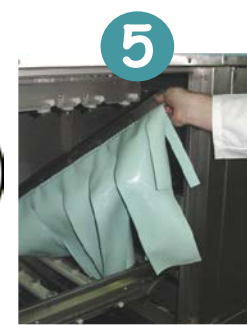
5 Démonter les rampes de rinçage et rideaux. Faire tremper dans une solution détartrante.
